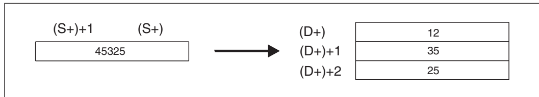
Abb. 7-157: Beispiel für die Anwendung einer DSTOH-Anweisung: 45325 Sekunden entsprechen 12 Stunden, 35 Minuten und 25 Sekunden.
