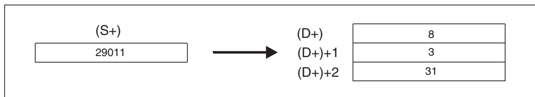
Abb. 7-155: Beispiel für die Anwendung einer STO H-Anweisung: 29011 Sekunden entsprechen 8 Stunden, 3 Minuten und 31 Sekunden.
